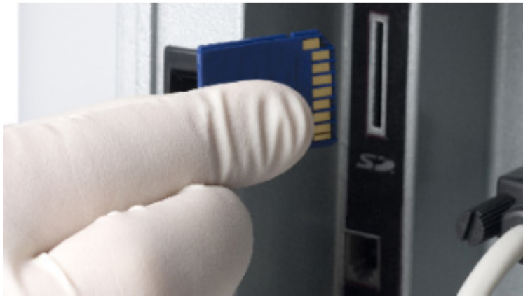
Figure 8.1 Installation de la carte SD
