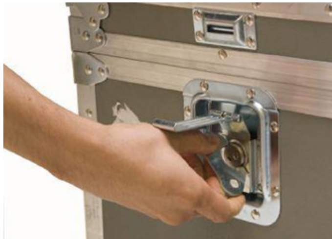
Figure 10.6 Déverrouillage de la caisse d'expédition réutilisable
