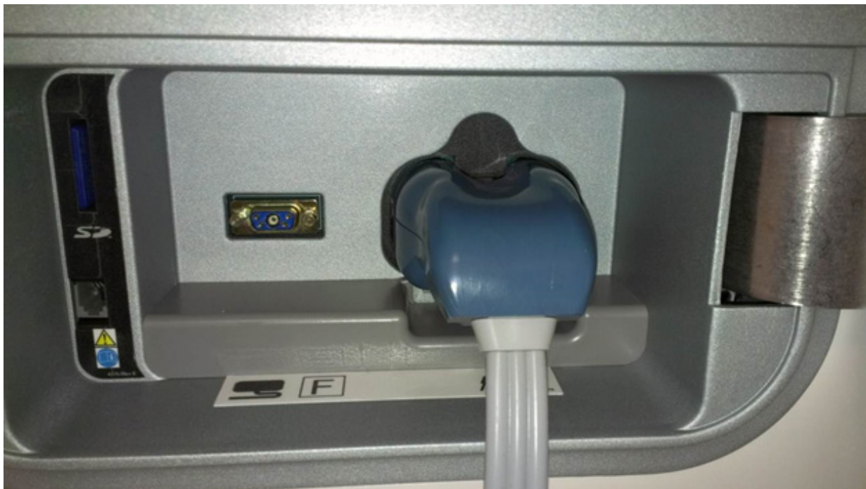
Figure 8.5 Câble de l'électrode de retour (gauche) et pièce à main (droite) branchés
